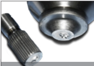
Разрушение шлицевой части
