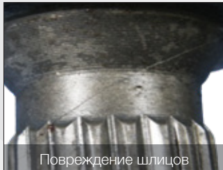
Разрушение шлицевой части
