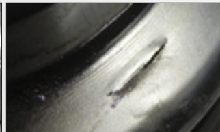
Порез на пыльнике
